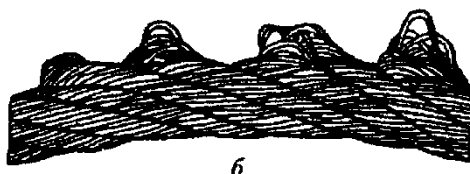
Рисунок 12. Выдавливание проволок прядей:
