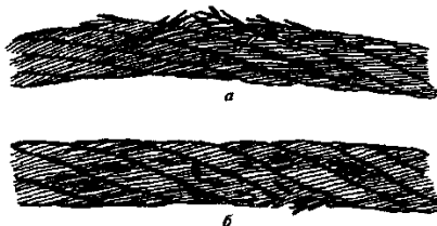
Рисунок 3. Обрывы проволок в зоне уравнильного блока: а - в нескольких прядях каната; б - в двух прядях в сочетании с местным износом
