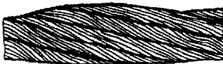
Рисунок 13. Местное увеличение диаметра каната
