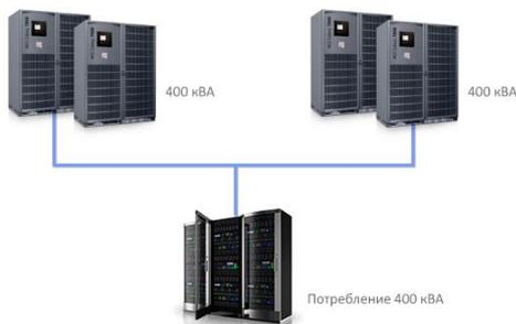
Рис. 2. Схема резервирования 2N
