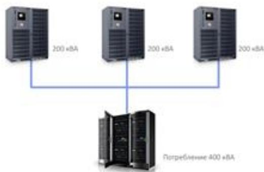
Рис. 1. Схема резервирования  $N + 1$
