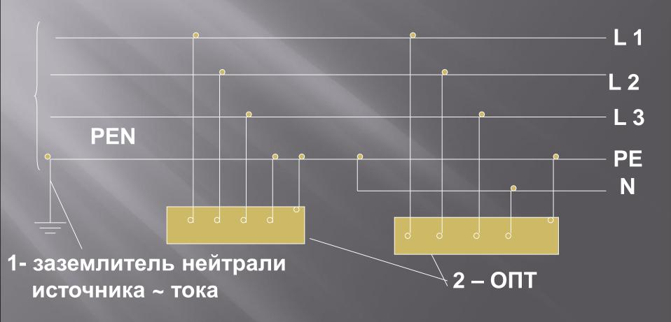
Системы IT —/~ тока (открытые проводящие части ЭУ заземлены; нейтраль источника питания изолирована от земли или заземлена через большое сопротивление)
