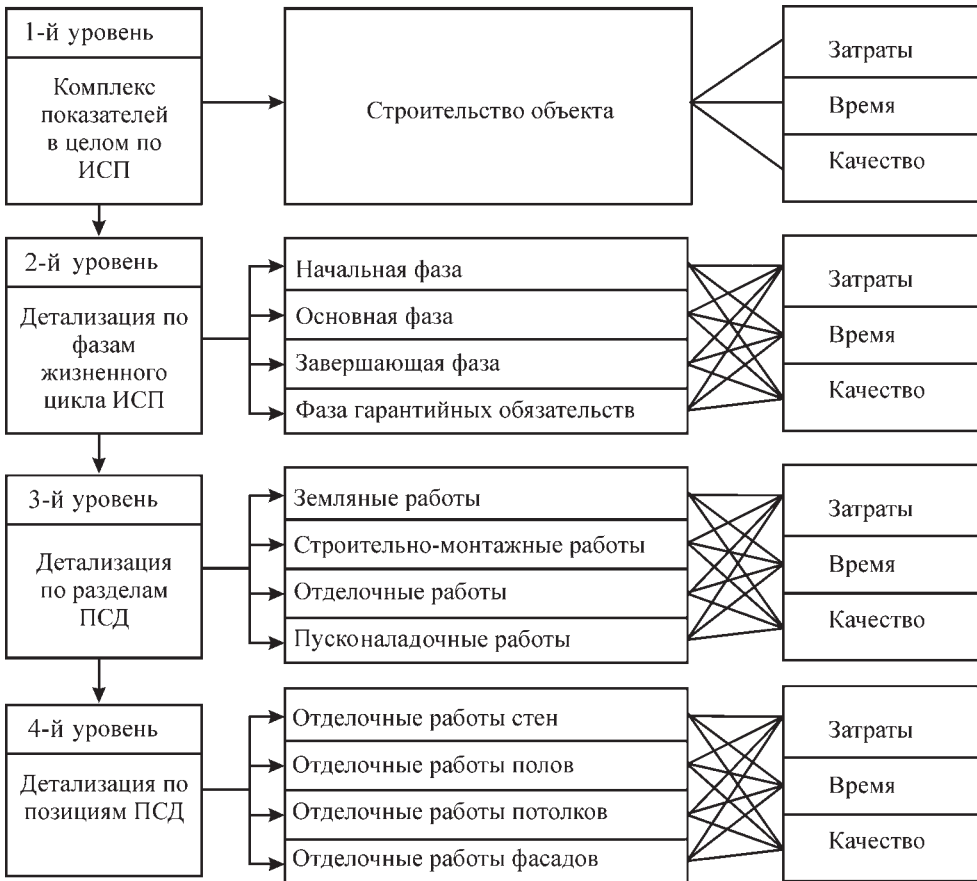
Рис. 5.3. Структура декомпозиции работ по реализации ИСП
