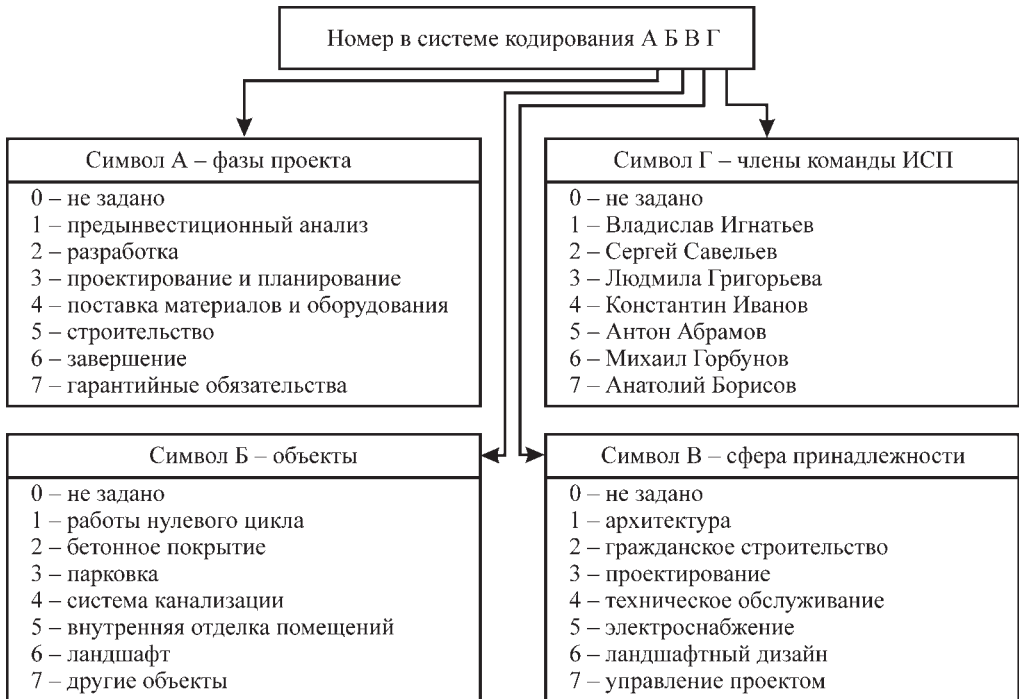
Рис. 7.6. Пример простой четырехзначной системы кодирования ИСП
