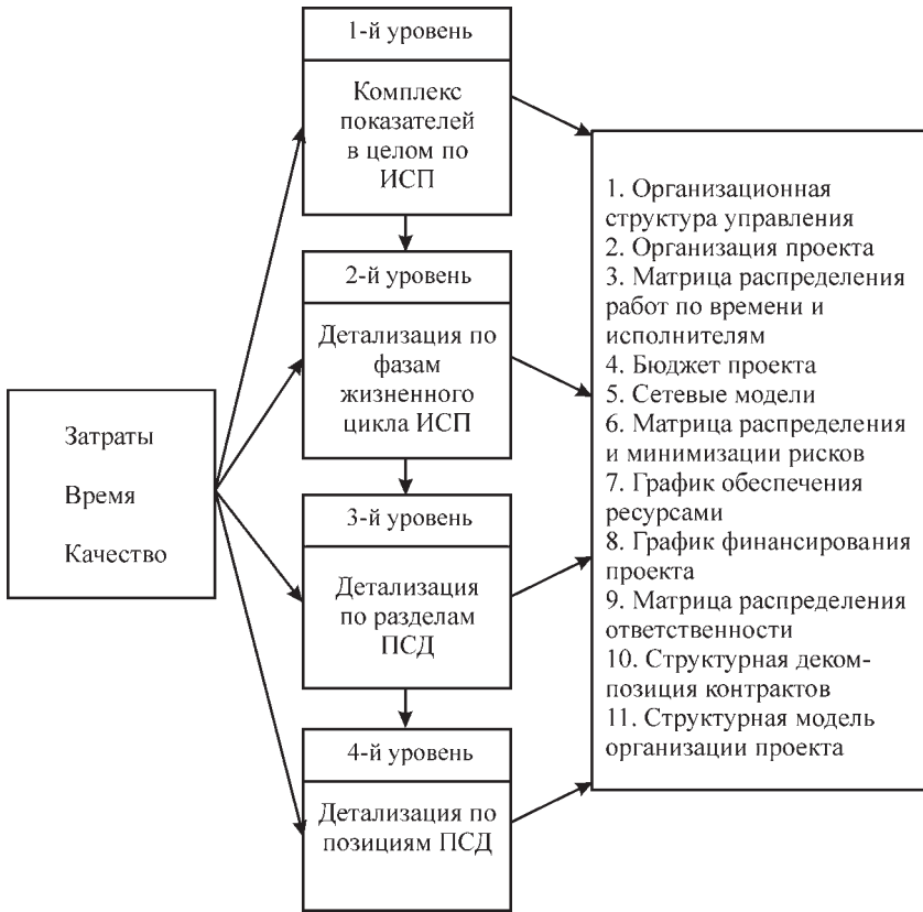
Рис. 5.2. Уровни структуры декомпозиции работ по реализации ИСП
