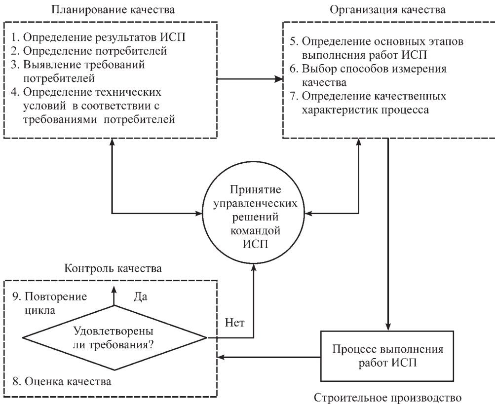
Рис. 8.4. Процесс улучшения качества ИСП
