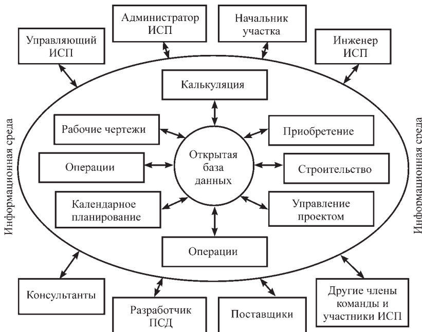
Рис. 10.3. Модель системы комплексно-автоматизированного строительства для ИСП
