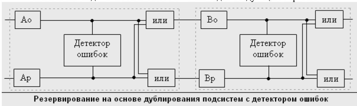
Здесь  $A_o$  и  $A_r$  составляют первый блок вычислительной системы, причем  $A_o$  – основной элемент, а  $A_r$  – резервный. Оба этих элемента, за исключением случая, когда один из них неисправен, имеют одинаковые выходы.
