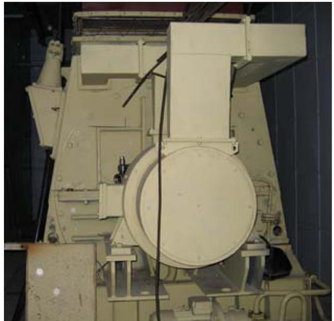
БВУ представляет собой небольшой по мощности генератор, который служит для питания ротора генератора постоянным током – током возбуждения. Таким образом, выработанная генерато-
